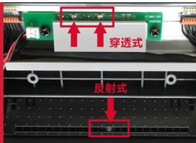
iQ100全能型专业面单打印机，配置反射式和穿透式两种纸张探测器，兼容各家快递物流公司面单打印，清晰明锐的打印效果令你赏心悦目。
